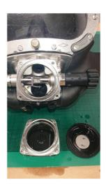
Innvendig ventil er synlig. Membran kan tas ut. Antibac sprayes på alle flater.
