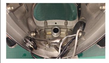
En del kriker og kroker. Spray med antibac over alt. La tørke. Skyld med ferskvann. Obs: Mikrofon må også sprayes.
